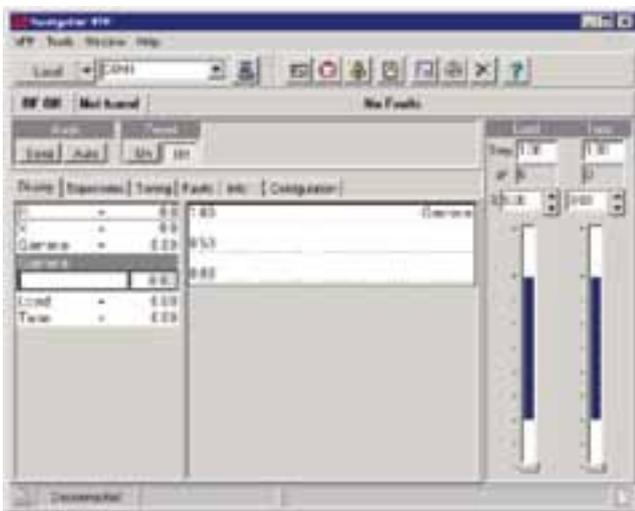
图 2, VFP 软件便于您使用个人电脑监测和控制 Navio™ 网络匹配器。
