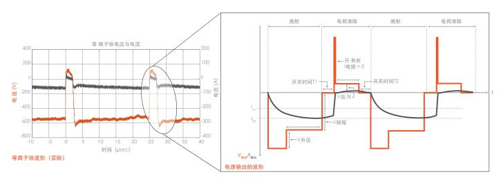
与正弦波中频交流电源相比较, 具有专利技术的升压电路加载在溅射波形的上升沿保证了功率的加速输出。对波形的反向部分进行最大限度的控制, 保证在反向阶段更加彻底的清除电荷。
